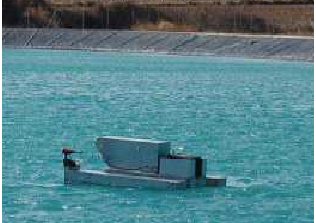
Limoscan realizando la medición de sedimentos en un punto del embalse.
